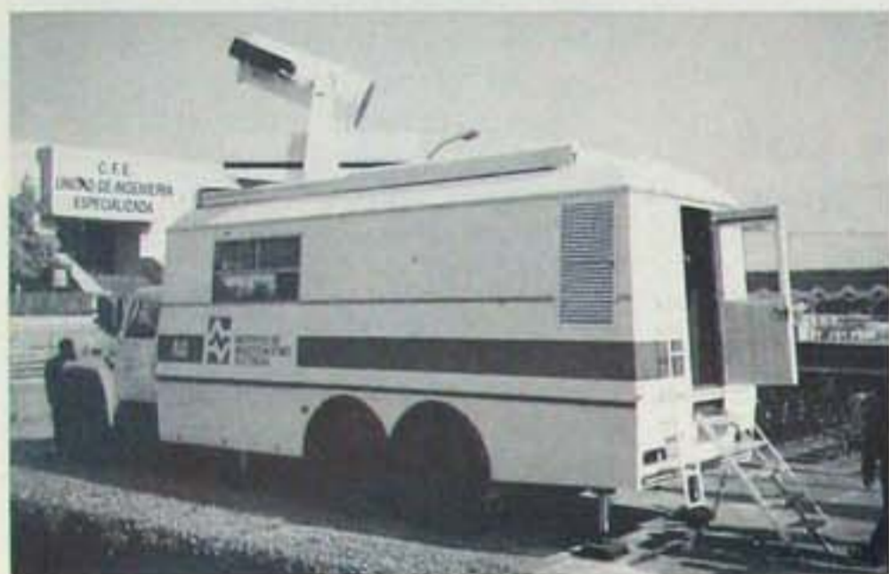
Il laboratorio mobile con sistema LIDAR-DIAL progettato e realizzato dal CISE, dono del governo italiano al governo messicano.
