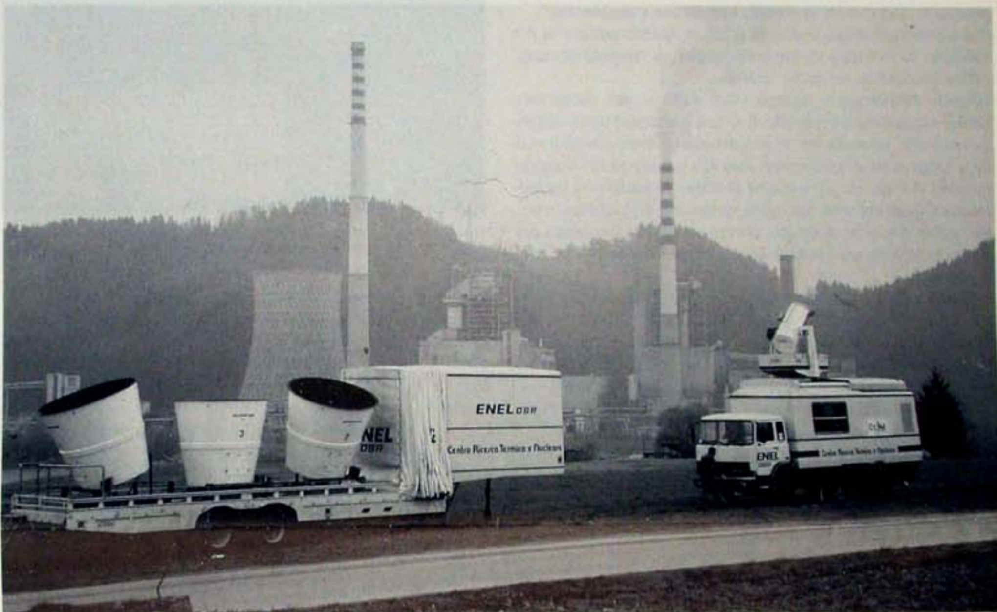
Le emissioni della centrale termoelettrica iugoslava di Sostanj sorvegliate da strumenti avanzati per misure ambientali: a sinistra, il SODAR del CRTN/ENEL; a destra, il LIDAR-DIAL del CISE sul laboratorio mobile del CRTN/ENEL, nel corso della recente campagna.
