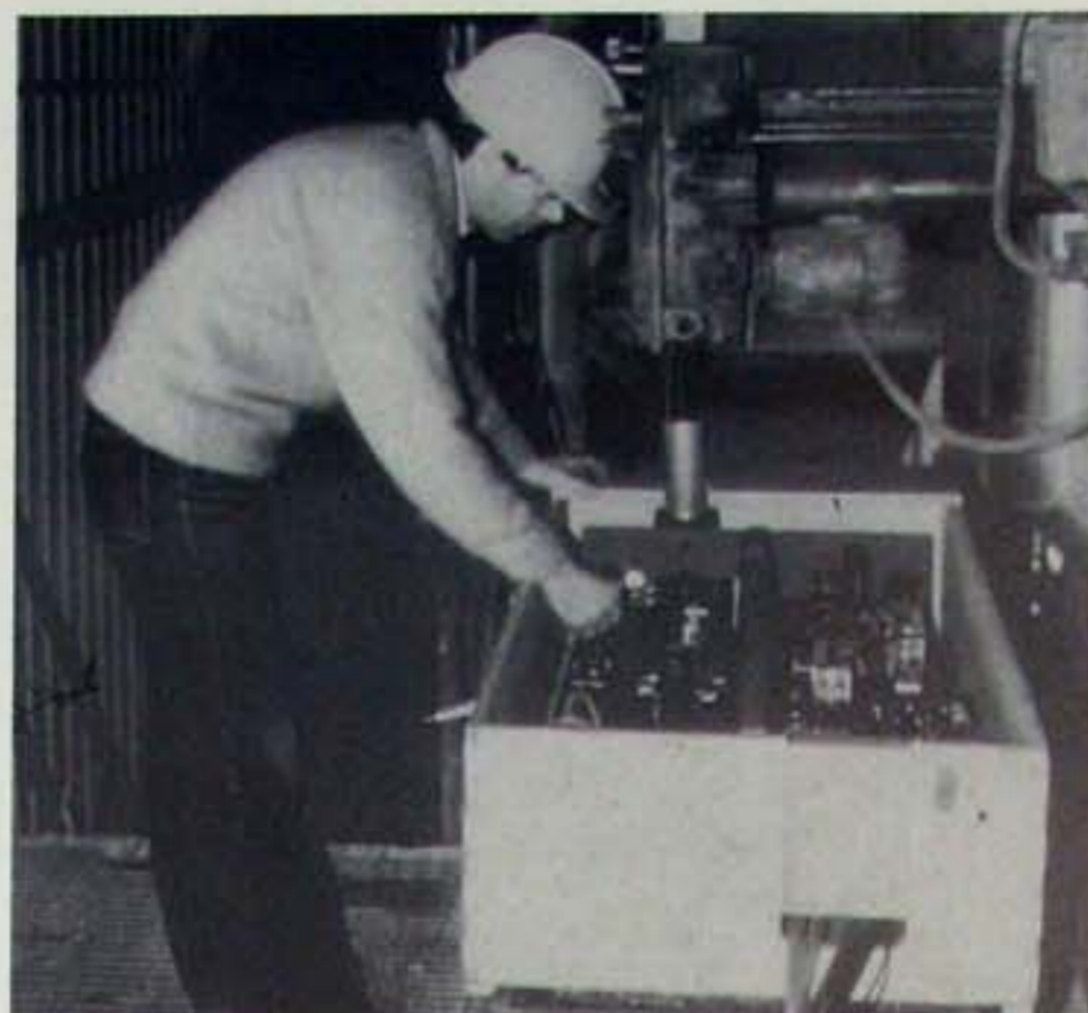
Maurizio Garbi durante la messa a punto del sistema CARS, per la misura di temperatura e concentrazione di gas nella camera di combustione.
